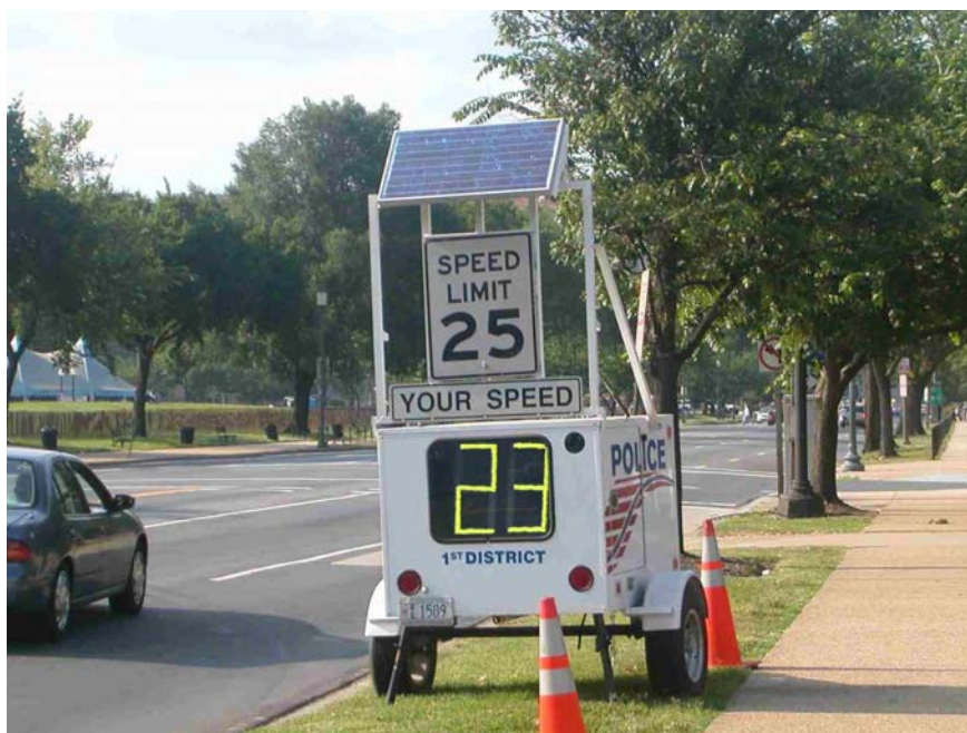
Figure 6.6. Panneau à messages variables affichant la limitation de vitesse en vigueur et la vitesse des véhicules (Etats-Unis)
