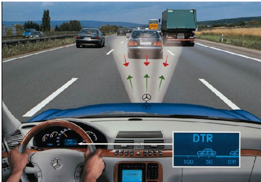
Figure 7.6. Principe du régulateur de vitesse adaptatif
