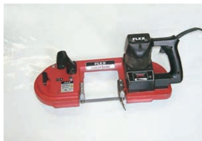
Matériel destiné à la découpe manuelle de petits tuyaux et conduits contaminés. Projet de démantèlement de BR-3, à Mol, en Belgique. [Photos : SCK•CEN]
