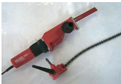
Matériel destiné à la découpe manuelle de petits tuyaux et conduits contaminés. Projet de démantèlement de BR-3, à Mol, en Belgique. [Photos : SCK•CEN]
