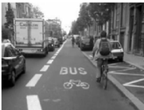
Un couloir de bus ouvert aux vélos est une voie réservée que se partagent les cyclistes et les bus. Il peut être unidirectionnel ou bidirectionnel, séparé du reste de la circulation par une marquage au sol ou un séparateur en relief.
