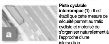
**Piste cyclable interrompue (1) :** Il est établi que cette mesure de sécurité permet au trafic cycliste et motorisé de s'organiser naturellement à l'approche d'une intersection.
