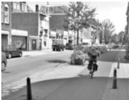
Une piste cyclable est une chaussée exclusivement réservée aux cyclistes. Elle est physiquement séparée (par la végétation, une barrière, le trottoir) de la chaussée, des files de stationnement et du trottoir. Une piste cyclable peut être unidirectionnelle ou bidirectionnelle et se situer d'un seul côté de la chaussée ou de part et d'autre.
