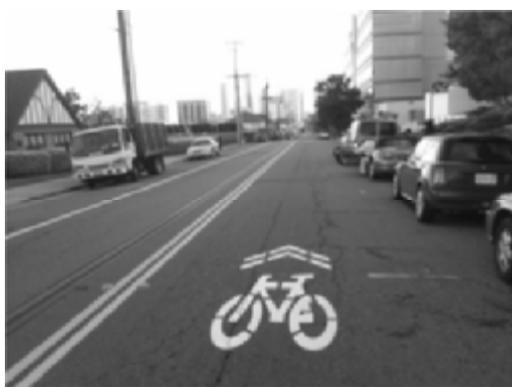
D'un point de vue technique et juridique, une bande conseillée n'est en aucun cas une bande cyclable. Il s'agit d'une partie de la chaussée recommandée aux cyclistes à l'aide d'un marquage sans qu'elle soit pour autant réservée à leur usage exclusif.
